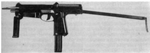
Rys. 10.13.9 mm pistolet maszynowy wz. 1963 z magazynkiem na 25 naboí, kolba wysunięta, uchwyt przedni otwarty
