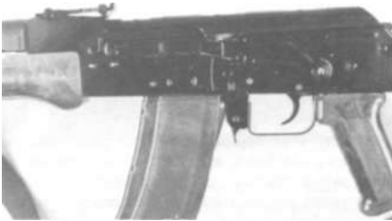
Rys.15.18. Dźwignia selektora ognia w karabinku wzór 1988
