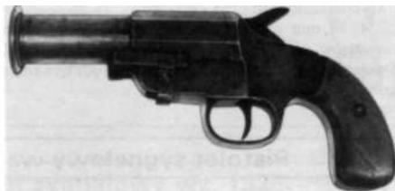
Rys. 7.2. Pistolet sygnałowy zastępczy produkcji "Warsztatów Broni DOG we Lwowie wz. 1919
