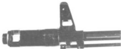
Rys.15.14. Urządzenie wy- lotowe karabinka AK-47 produkcji radzieckiej
