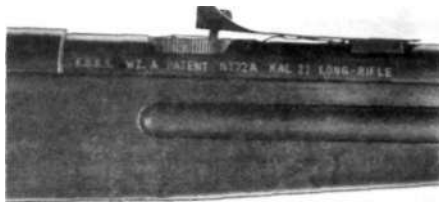
Rys. 21.6. Celownik śrubowy karabinka sportowego wz. 1930 AL — przedmiot patentu polskiego nr 16123
