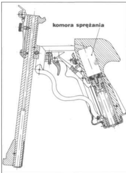
Rys. 21.24. Pistolet pneumatyczny Łucznik wz. 1970 w położeniu ze „złamaną” lufą
