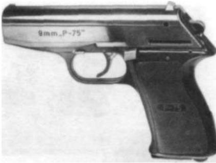
Rys. 6.17. 9 mm pistolet wz. P-75; wersja bez bezpiecznika
