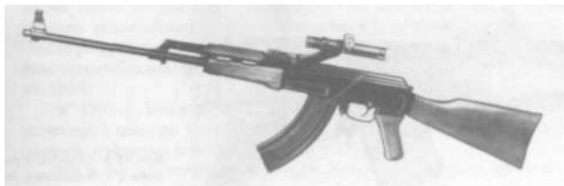
Rys. 15.2. Karabinek AK z lunetą PU; wersja z 1957 r.
