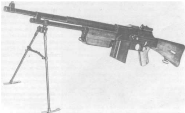
Rys. 16.1. 7,92 mm ręczny karabin maszynowy wz. 1928 produkcji Fabryki Karabinów w Warszawie przełącznika rodzaju ognia spełniał bezpiecznik umieszczony **lewej strony uchwytu.
