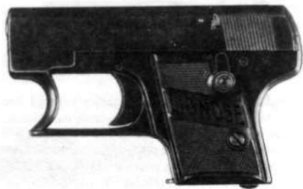
Rys. 5.2. 6,35 mm pistolet Lignose model 2A z urządzeniem inż. Chylewskiego
