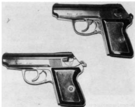
Rys. 6.11. Pistolet wz. P-64 U góry pierwsza wersja produkcyjna, u dołu broń w drugiej wersji produkcyjnej wytwarzanej od roku 1972 z kurkiem typu A
