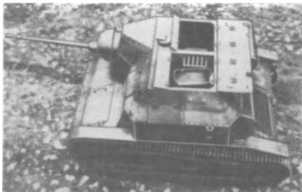
Rys. 20.3. 20 mm najcięższy karabin maszynowy wz. 38FK (model A) zamontowany na czołgu rozpoznawczym TKS
