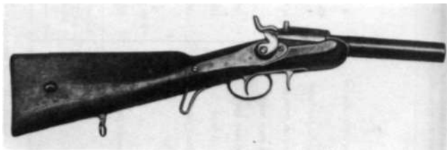
Rys. 7.1. 26 mm pistolet sygnałowy kolbowy wz. 1919 przerobiony z karabinu Werdla wz. 1873 produkcji Warsztatów Broni DOG we Lwowie
