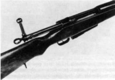
Rys. 13.4. Karabin ppanc. wz. 1935. Zamek i komora zamkowa
