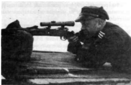
Rys. 12.2. Luneta PZO osadzona lewobocznie. Strzelec celuje, opierając policzek o poduszkę na karabinie
