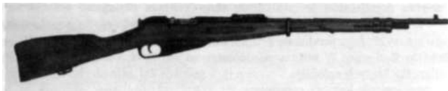
Rys. 11.7. 7,92 karabinek wz. 1891/98/25 przerobiony z 7.62 mm rosyjskiego Mosina wz. 1891
