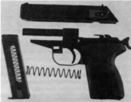
Rys. 6.20- Podstawowe zespoły pistoletu wz. P-83
