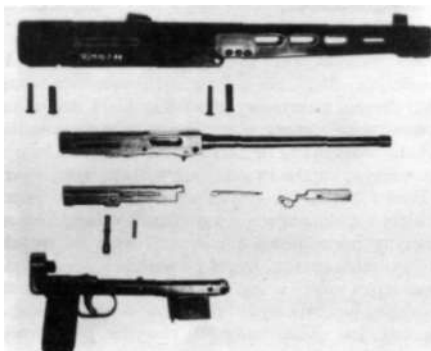
Rys. 10.7. Podstawowe części i zespoły pistoletu wz. AJ-56
