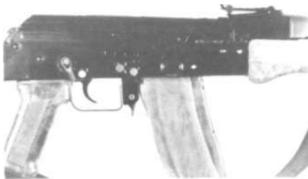
Rys. 15.17. Dźwignia bezpiecznika w 5,45 mm karabinku wzór 1988
