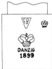
Rys.23.5. Cechy stawiane na kb Mauser wz. 1898, przechodzących renowację w Fabryce Broni w Radomiu
