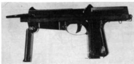
Rys. 10.13.9 mm pistolet maszynowy wz. 1963 z magazynkiem na 25 naboí, kolba wysunięta, uchwyt przedni otwarty
