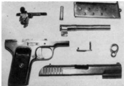
Rys.6.2. Podstawowe części i zespoły 5,6 mm treningowej wersji pistoletu pw wz. 35
