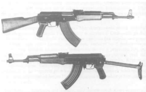
Rys. 15.1. 7.62 mm karabinek AK produkcji polskiej. U góry z kolbą stałą, u dołu z kolbą składaną
