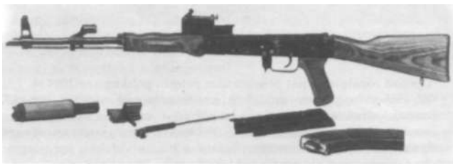
Rys. 15.10. Podstawowe części i zespoły 5,6 mm AKM na nabój sportowy bocznego zapłonu
