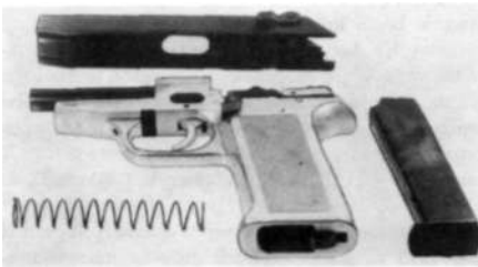
Rys. 6.13. Podstawowe części i zespoły pistoletu wz. P-70
