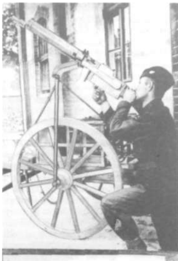
Rys. 18,9. Podstawa CSS do lekkiego karabinu maszynowego wz. 1908/15 na biedce
