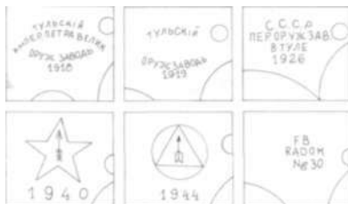
Rys. 23.21. Znaki firmowe stosowane na 7,62 mm rewolwerach Nagania w latach 1895-1945
