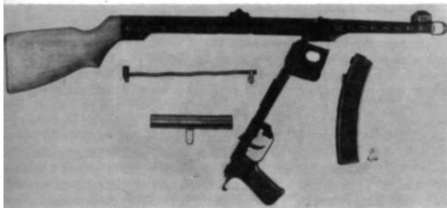
Rys. 10.4. Podstawowe zespoły pistoletu PPS wz. 1943/52
