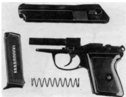
Rys. 6.10. Podstawowe części i zespoły pistoletu wz. P-64
