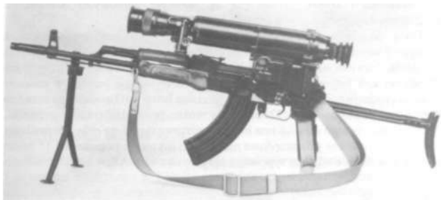
Rys. 15.8. Karabinek AK z noktowizorem wyposażony w szczelinowy tłumik płomieni i lekki składany dwójnóg
