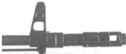
Rys. 15.15. Urządzenie wy- lotowe umożliwiające mio- tanie granatów nasadko- wych w karabinku produkcji polskiej
