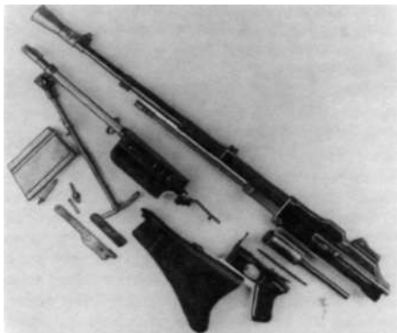
Rys. 16.2. Podstawowe części i zespoły ręcznego karabinu maszynowego wz. 1928
