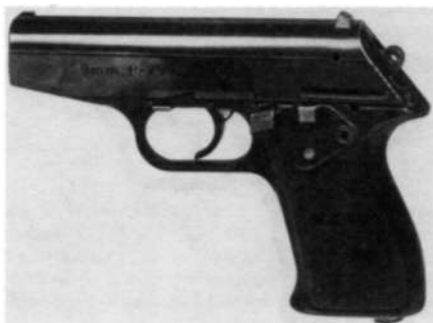
Rys. 6.16. 9 mm pistolet wz. P-75; wersja z bezpiecznikiem umieszczonym z lewej strony szkieletu broni
