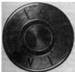
Rys. 3.9. Znakowanie dna łuski amunicji Mausera wytwórni „Pocisk”
