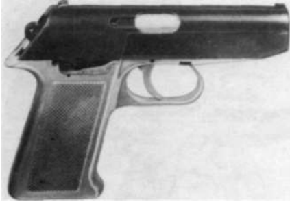
Rys. 6.12. 9 mm pistolet wz. P-70. Szkielet ze stopu aluminium
