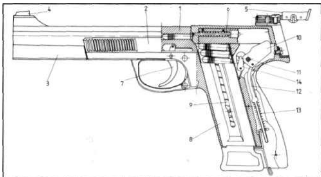
Rys. 21.16. 5,6 mm pistolet sportowy konstrukcji Ernesta Durasiewicza:
